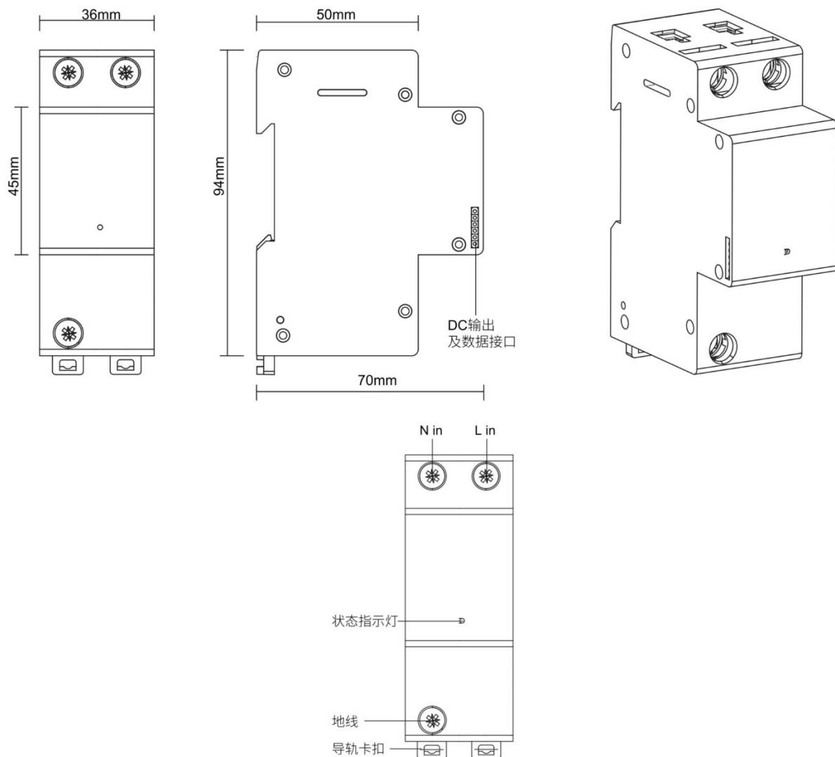
图 10: S3 系列智慧微断匹配智能电源模组示意图（三相举例）
