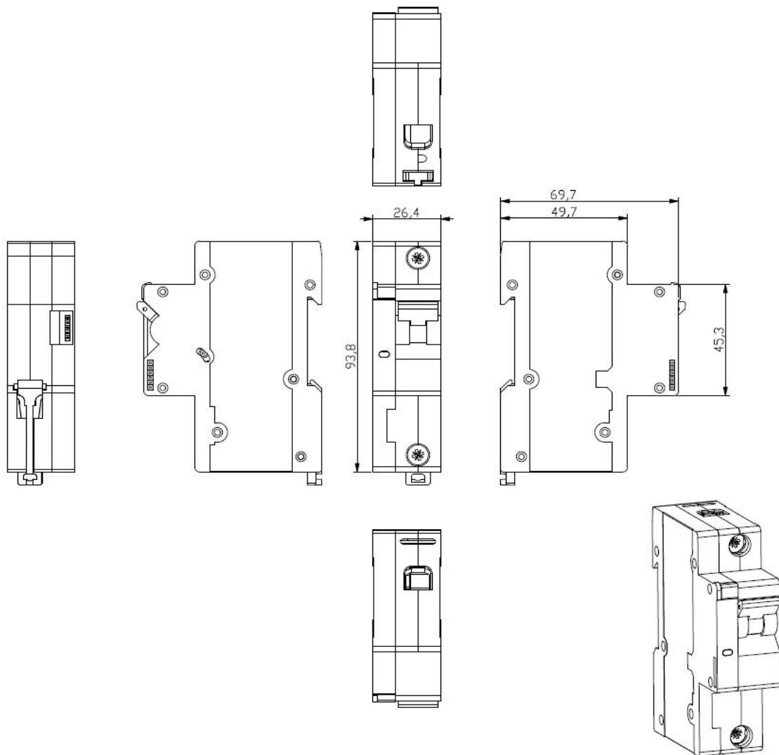
图 1: S3-F 智慧微断产品示意图
