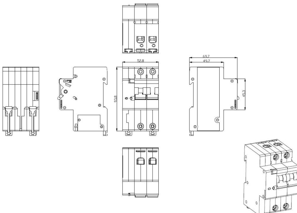
图2：S3-FN/S3-FNL 智慧微断产品示意图
