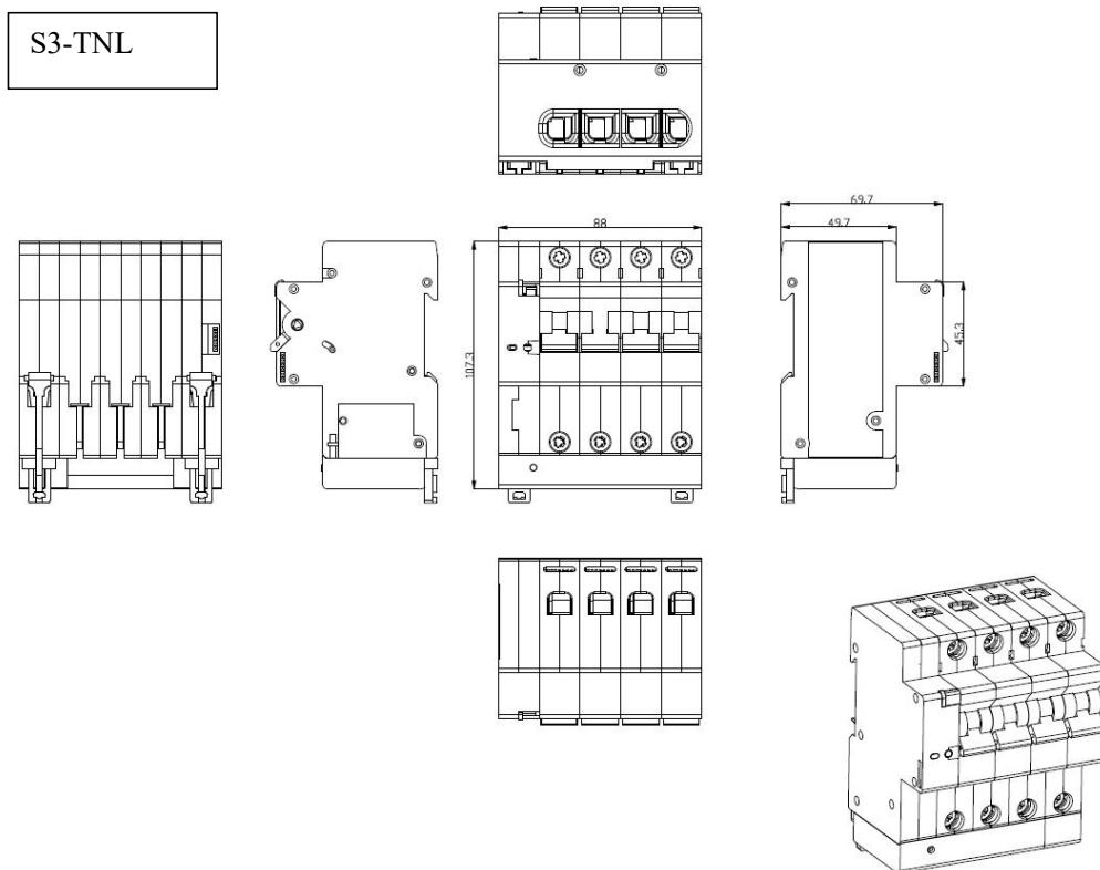
图 6: S3-TNL 智慧微断产品示意图
