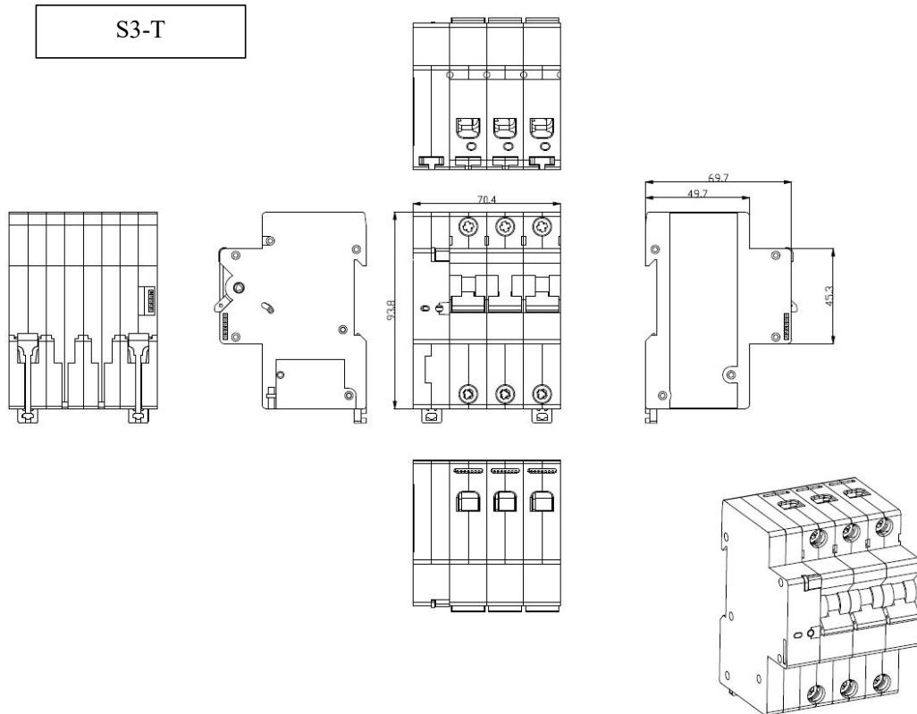
图 3: S3-T 智慧微断产品示意图
