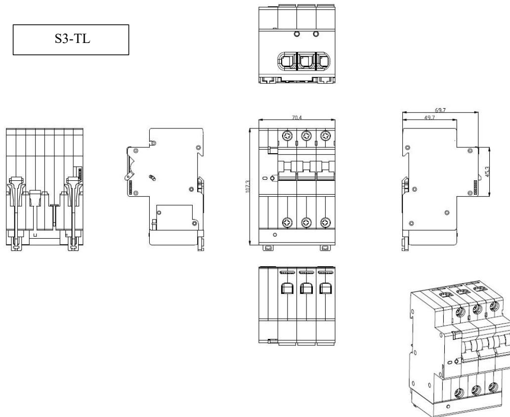
图5: S3-TL 智慧微断产品示意图
