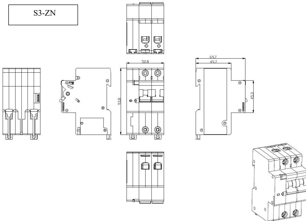
图 7: S3-ZN 智慧微断产品示意图
