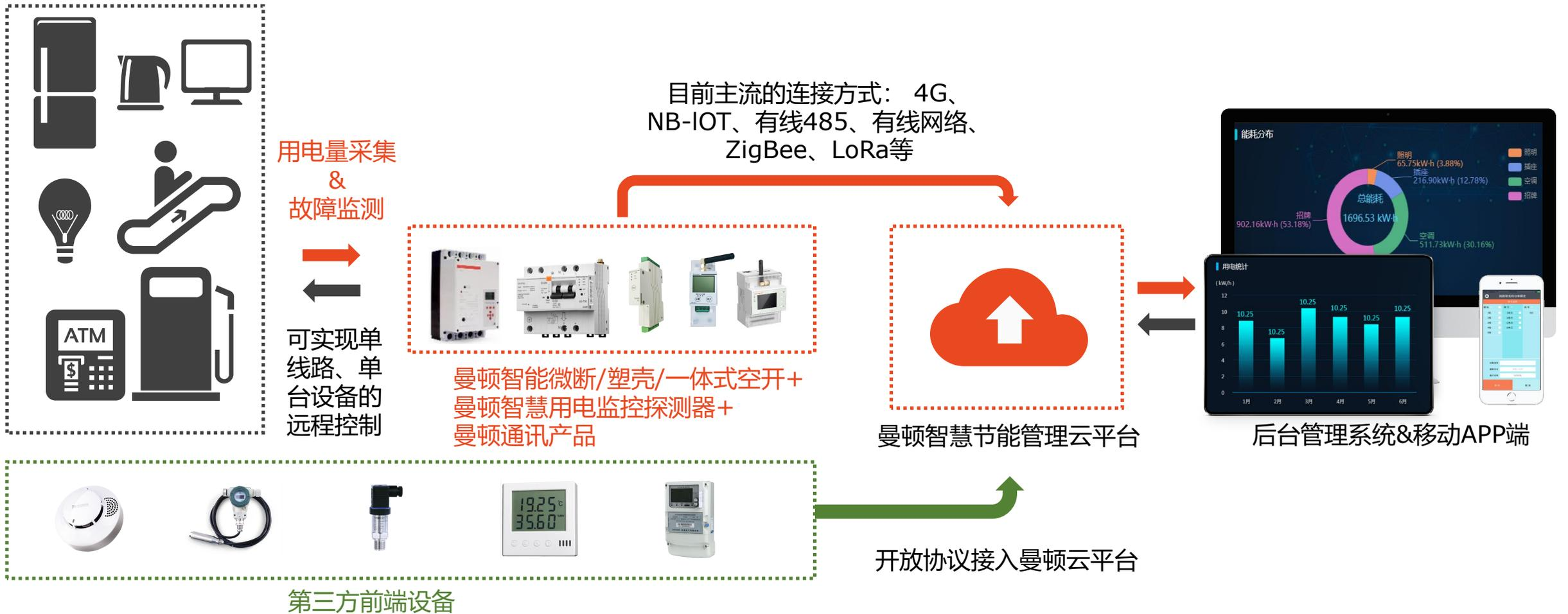
曼顿微断内置芯片和传感器，自行判断负载和故障，智能检测设备增减，实时、有效
