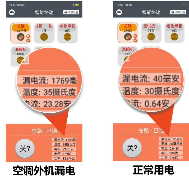
2020年7月，通过曼顿智慧空开，及时发现空调外机漏电，成功规避电气安全事故
